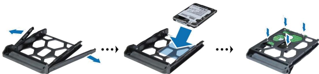
**4** Поверните жесткий диск стороной с отметкой “UP” кверху и вставьте его в отсек для жестких дисков. Если лоток вставлен правильно, раздастся щелчок.
