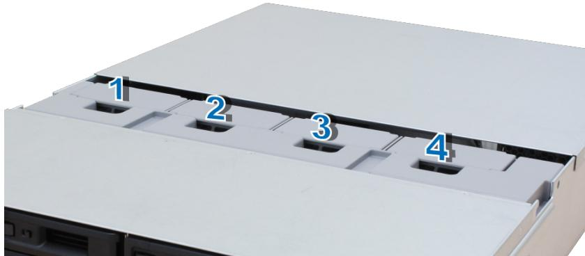
**4** Найдите неисправный вентилятор. Поднимите вентилятор вверх и снимите его.
