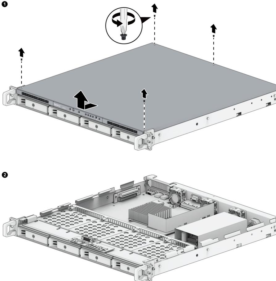
**Примечание.** После снятия верхней крышки задней части устройства чувствительные внутренние компоненты остаются без защиты от внешних воздействий. Не трогайте внутренние компоненты, кроме блока памяти при его извлечении или установке.
