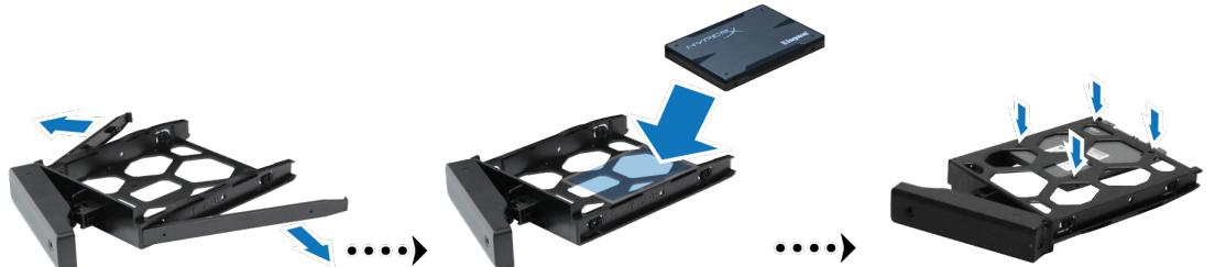
**4** Вставьте лоток с установленным жестким диском в пустой отсек для дисков.
