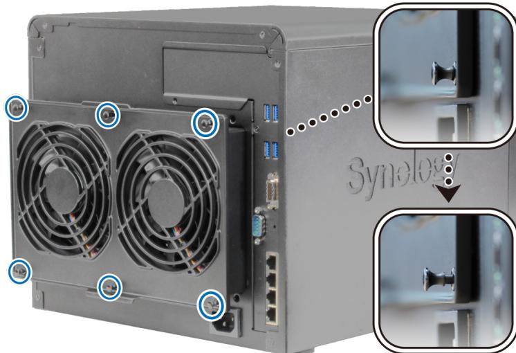
3 Для удаления модуля неисправного вентилятора его необходимо просто вытащить из DiskStation.
