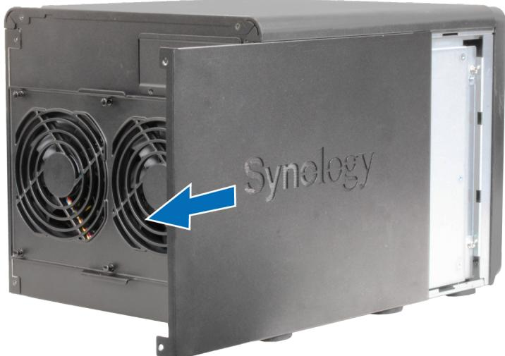
**Примечание.** При снятии крышки вы подвергаете чувствительные внутренние компоненты внешнему воздействию. Не трогайте внутренние компоненты за исключением блока памяти, который вы собираетесь извлечь или добавить.
