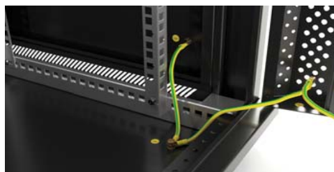
Используя заземляющие провода, подключите все металлические элементы шкафа к предусмотренным для них узлам заземления. На завершающем этапе подключите главный заземляющий контакт шкафа к существующей в здании общей системе заземления.
