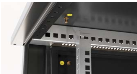
Как крыша, так и основание шкафа содержат по 2 резьбовые шпильки (всего 4 шт.), через которые с помощью проводов заземления можно подключить все металлические элементы шкафа, оснащенные наконечниками под разъёмный соединитель (одно- или двусторонние контакты типа лепесток).
