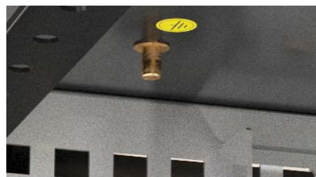
Как крыша, так и основание шкафа содержат по 2 резьбовые шпильки (всего 4 шт.), через которые с помощью проводов заземления можно подключить все металлические элементы шкафа, оснащенные наконечниками под разъёмный соединитель (одно- или двусторонние контакты типа лепесток).
