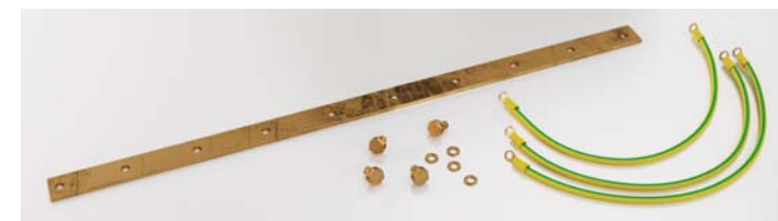
При необходимости, помимо сборки простейшего заземляющего контура (на основе только лишь заземляющих проводов), заземление можно организовать с использованием 19” заземляющей шины TGRD-19 и кабелей заземления TGRD-CAB-80 (заказываются отдельно).
