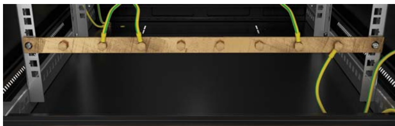
Заземляющая шина подключается к одной из шпилек заземления. К установленной шине необходимо подключить внешний заземлитель, а также все установленное оборудование. Для каждой единицы оборудования должен использоваться отдельный заземляющий провод.
