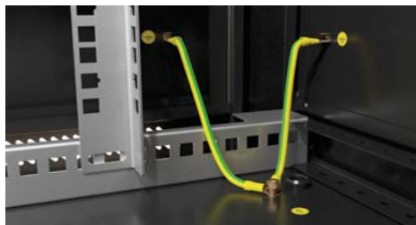
Система заземления телекоммуникационного шкафа реализуется с помощью комплекта заземляющих проводов, которые соединяют все металлические элементы шкафа в единый контур заземления.
