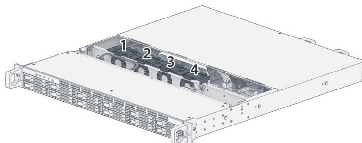
**4** Отыщите неисправный вентилятор. Чтобы снять вентилятор, поднимите его.
