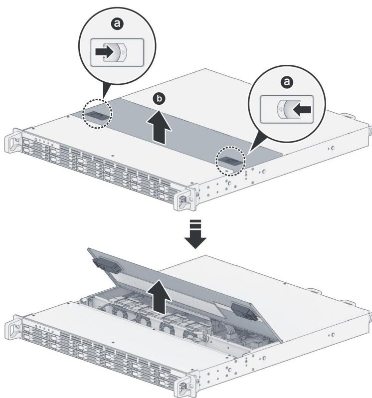
**3** Отвинтите винт на верхней крышке задней части. Сдвиньте верхнюю крышку задней части устройства, чтобы открыть ее, а затем поднимите и отложите ее в сторону.
