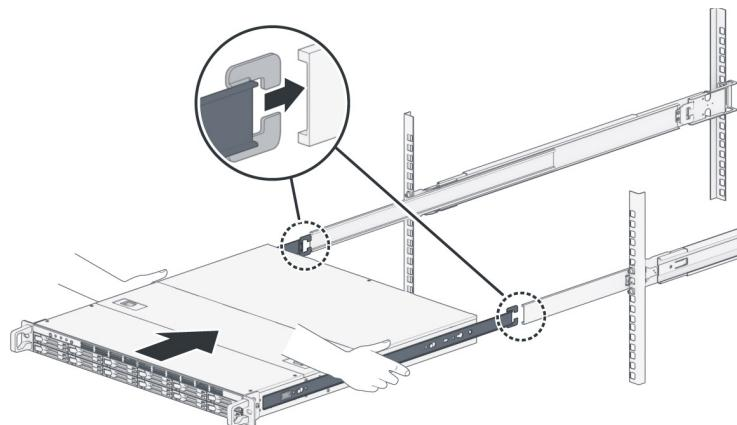
**4** Потяните переднюю защелку внутренней направляющей, как показано на рисунке, чтобы разблокировать ее, и сдвиньте шасси в сторону стойки.
