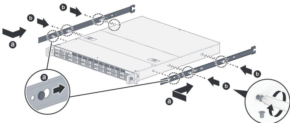
**3** Вместе с помощником аккуратно совместите внутренние направляющие с узлом внешней направляющей и сдвиньте шасси в сторону стойки.
