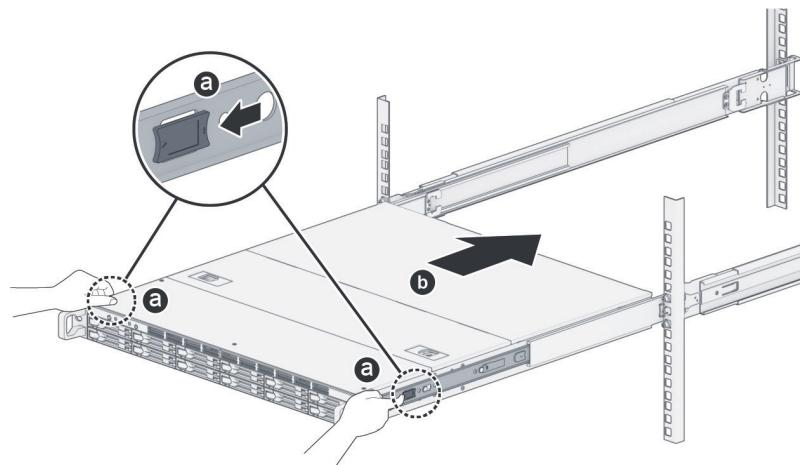
**5** Вставьте шасси в конец стойки и прикрепите заушины к стойке.
