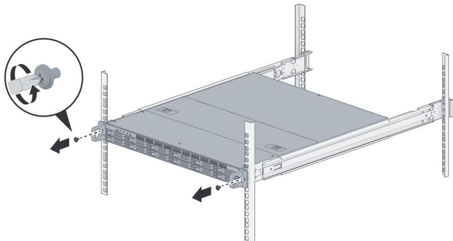
2 Выдвиньте шасси из стойки.
