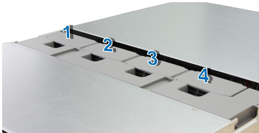
4 Найдите неисправный вентилятор. Поднимите вентилятор вверх и снимите его.
