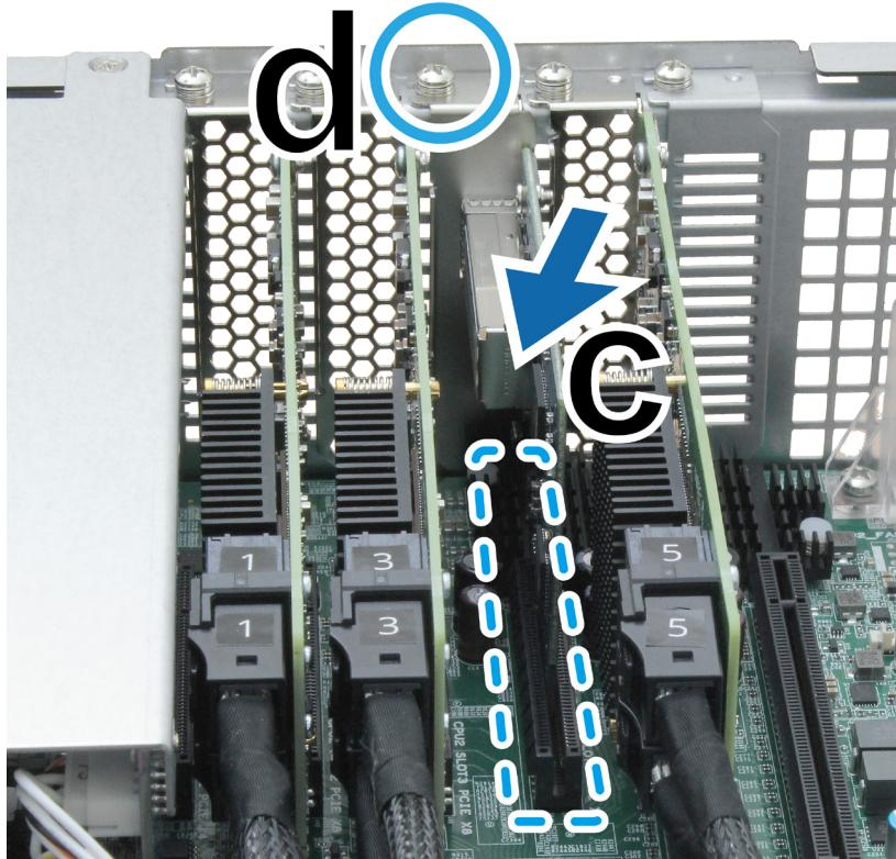
**4** Повторите шаг 3 для установки другой дополнительной платы на FlashStation.
