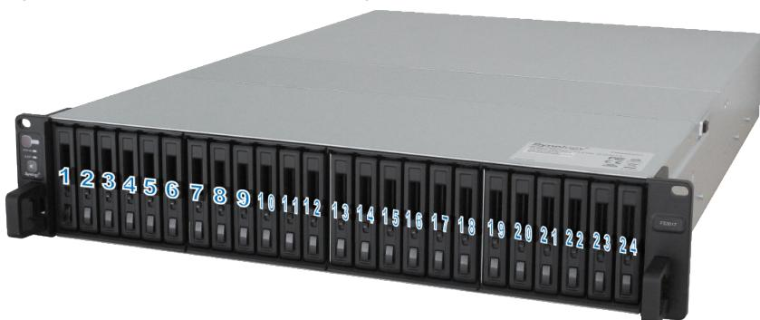
**Примечания** Для создания тома RAID рекомендуется использовать жесткие диски одного размера, чтобы оптимизировать использование объема жестких дисков.
