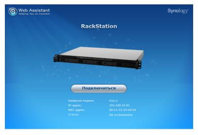
5 Нажмите кнопку Подключиться, чтобы начать процесс установки, и следуйте инструкциям на экране.
