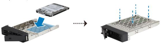
3 Вставьте лоток с установленным жестким диском в пустой отсек для дисков.
