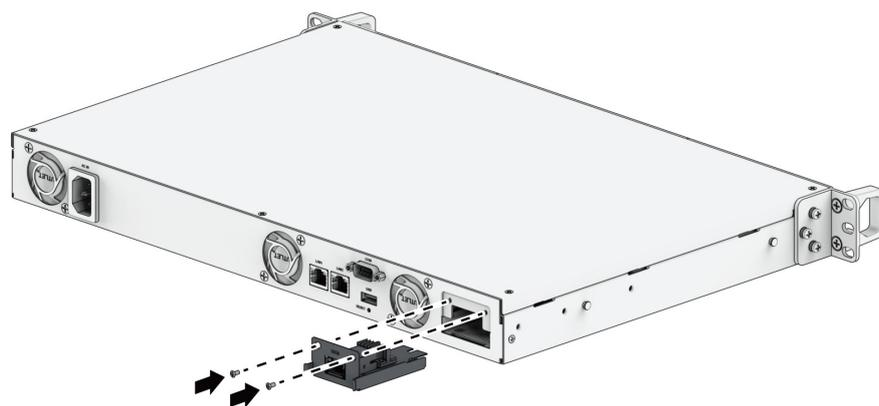
**Примечание.** Убедитесь, что сетевой модуль модернизации вставлен полностью. В противном случае могут возникнуть сбои в работе сетевого модуля модернизации.
