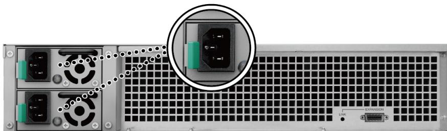
**Примечание.** Устройство RX1217RP поставляется с запасной системой электропитания, которая позволяет подключение двух кабелей питания. Систему можно включить только с помощью одного кабеля питания, но во избежание сбоев питания рекомендуется использовать два кабеля.
