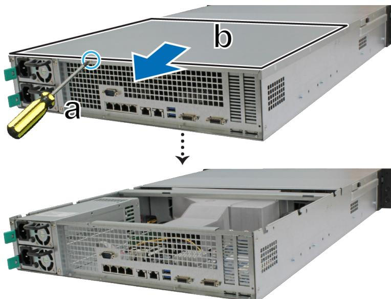
**Примечание.** После снятия верхней крышки задней части устройства чувствительные внутренние компоненты остаются без защиты от внешних воздействий. Не трогайте внутренние компоненты, кроме блока памяти при его извлечении или установке.
