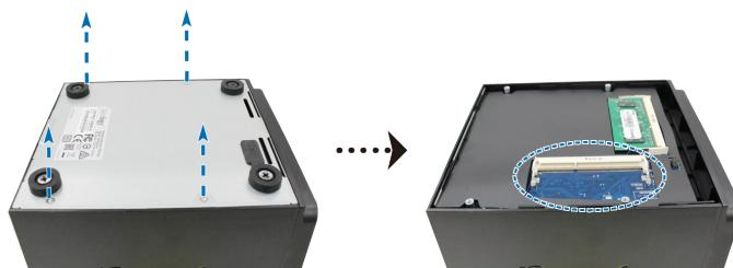
**Важно!** После снятия панели чувствительные внутренние компоненты остаются без защиты от внешних воздействий. Не трогайте внутренние компоненты за исключением блока памяти, который вы собираетесь извлечь или добавить.
