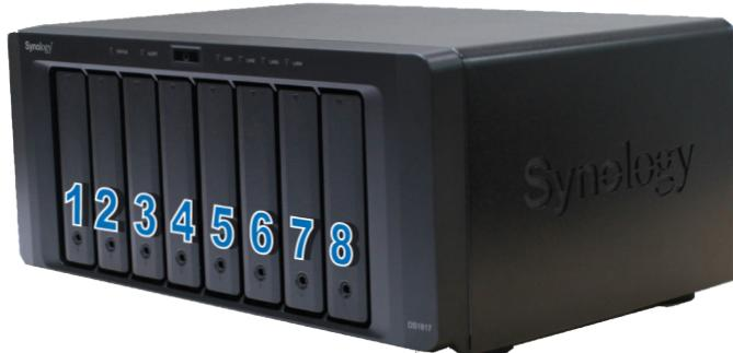
**Примечание.** При необходимости создать том RAID рекомендуется, чтобы все установленные жесткие диски были одного размера для максимального использования дискового пространства.
