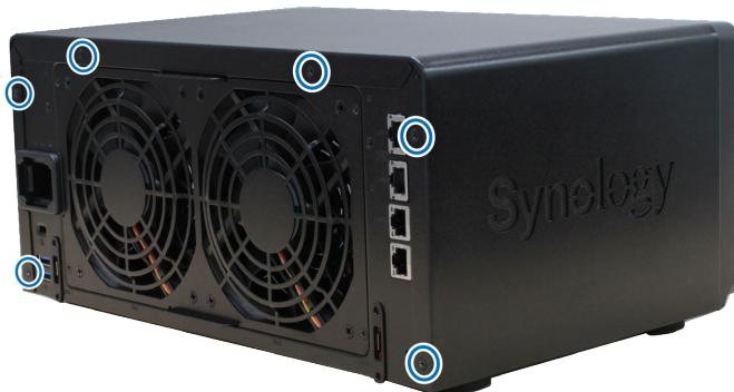
**Важно!** При снятии крышки вы подвергаете чувствительные внутренние компоненты внешнему воздействию. Не трогайте внутренние компоненты за исключением блока памяти, который вы собираетесь извлечь или добавить.
