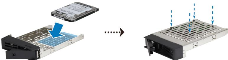
3 Вставьте лоток с установленным диском в пустой отсек для дисков.
