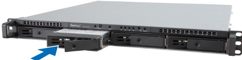
**Важно!** Убедитесь в том, что лоток для жестких дисков задвинут полностью; в противном случае диск не будет работать надлежащим образом.
