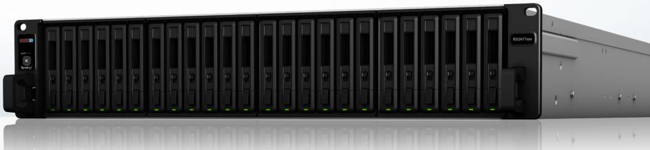
Synology RX2417sas — простое решение для расширения тома и резервного копирования данных на устройствах Synology FlashStation<sup>1</sup>/RackStation<sup>2</sup>. Это решение позволяет добавить 24 отсека для дисков SAS/SATA без остановки работы системы. На Synology RX2417sas предоставляется 5-летняя ограниченная гарантия от компании Synology.
