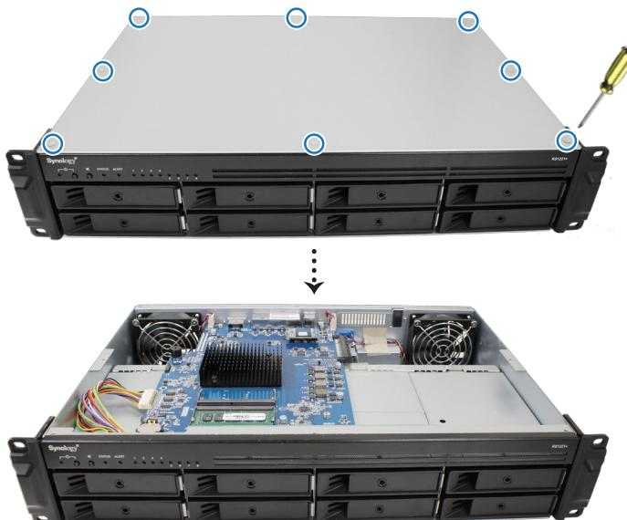
**Примечание.** После снятия верхней крышки чувствительные внутренние компоненты остаются без защиты от внешних воздействий. Не трогайте внутренние компоненты, кроме блока памяти при его извлечении или установке.
