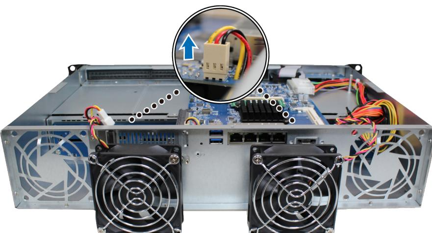
**b** Выкрутите винты, с помощью которых крепится решетка неисправного вентилятора.
