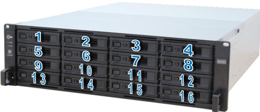
**Примечание.** Для создания тома RAID рекомендуется использовать жесткие диски одного размера, чтобы оптимизировать использование объема жестких дисков.
