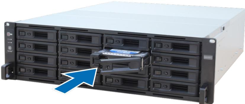
**Примечание.** Убедитесь, что лоток задвинут до упора. В противном случае в работе диска могут возникнуть неполадки.
