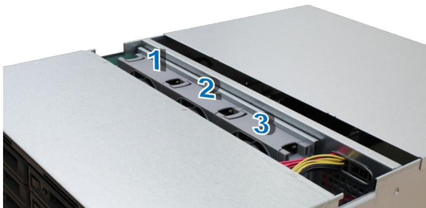
**4** Отыщите неисправный вентилятор. Поднимите вентилятор вверх и снимите его.
