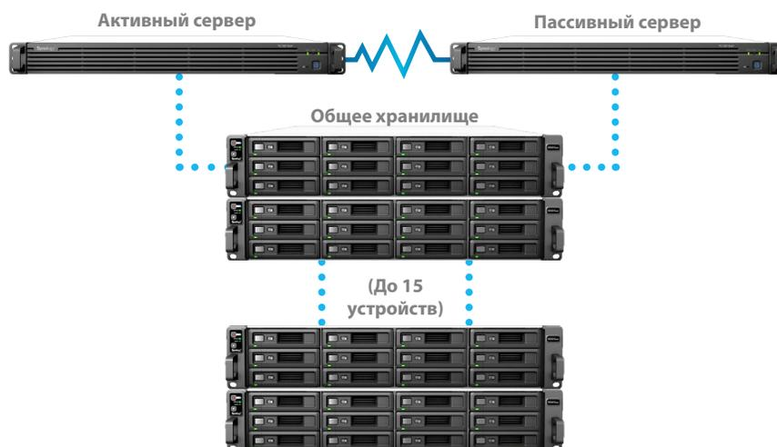
Подключенное устройство RXD1215sas выполняет функции общего хранилища двух серверов, что устраняет необходимость выполнения репликации данных и позволяет экономить энергию и пространство в стойке. Объем хранилища можно увеличить за счет подключения к кластеру HA дополнительных устройств RXD1215sas (до 15 комплектов) с возможностью масштабирования до 180 жестких дисков и максимальной общей емкостью более 1 петабайта.
