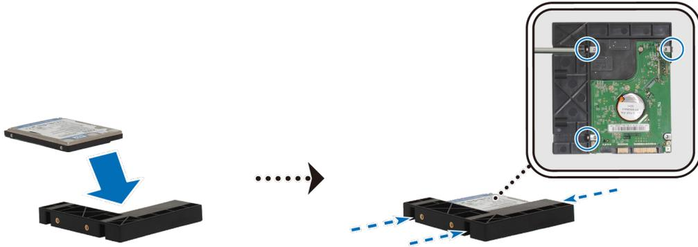
б Установите держатель дисков 2,5 дюйма в отсек для дисков и продвиньте вперед, пока диск не подключится к разъему SATA. Зафиксируйте держатель диска с помощью винтов, входящих в комплект поставки.
