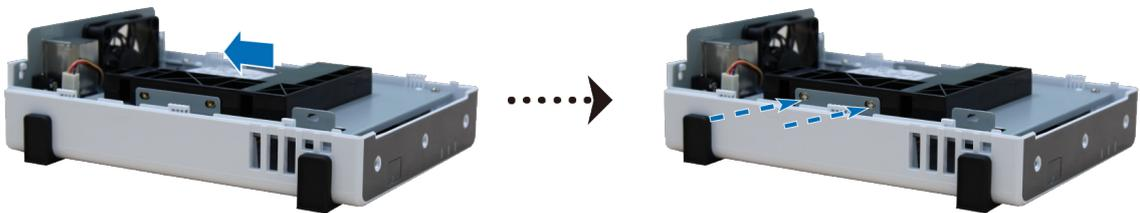
3 Установите на место верхнюю крышку и затяните шурупы на задней панели.
