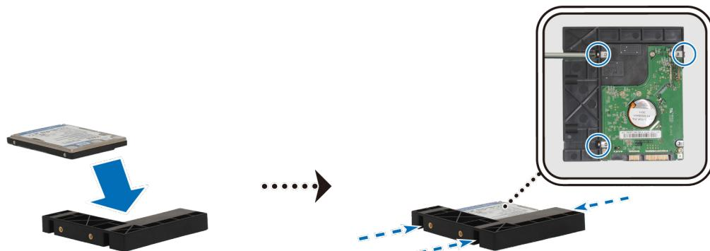
**b** Установите держатель дисков 2,5 дюйма в отсек для дисков и продвигните вперед, пока диск не подключится к разъему SATA. Зафиксируйте держатель диска с помощью винтов, входящих в комплект поставки.
