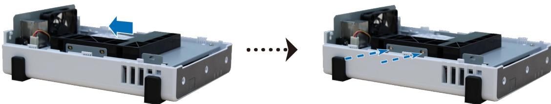
**3** Установите на место верхнюю крышку и затяните шурупы на задней панели.
