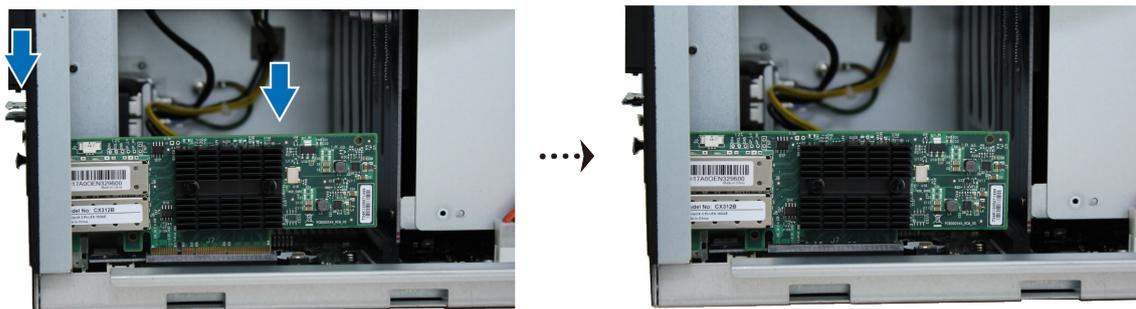
**с** Задвиньте фиксатор, чтобы зафиксировать только что вставленную плату.
