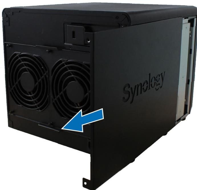
**Примечание.** При снятии крышки вы подвергаете чувствительные внутренние компоненты внешнему воздействию. Не трогайте внутренние компоненты за исключением блока памяти, который вы собираетесь извлечь или добавить.
