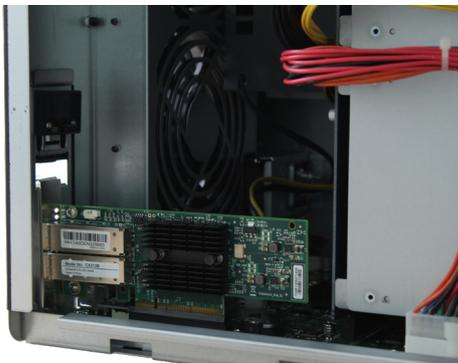
**в** Двумя пальцами равномерно надавите на плату и зажим.
