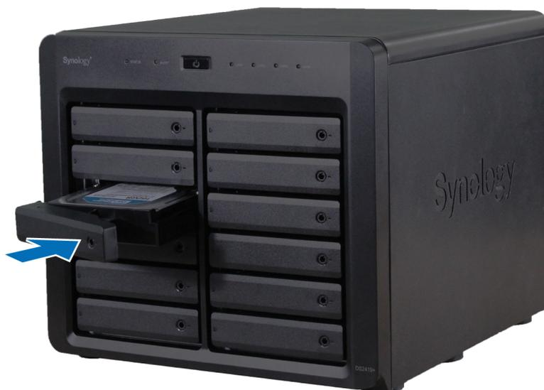
**Примечание.** Убедитесь, что лоток задвинут до упора. В противном случае в работе диска могут возникнуть неполадки.
