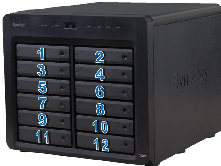
**Примечание.** При необходимости создать том RAID рекомендуется, чтобы все установленные жесткие диски были одного размера для максимального использования дискового пространства.
