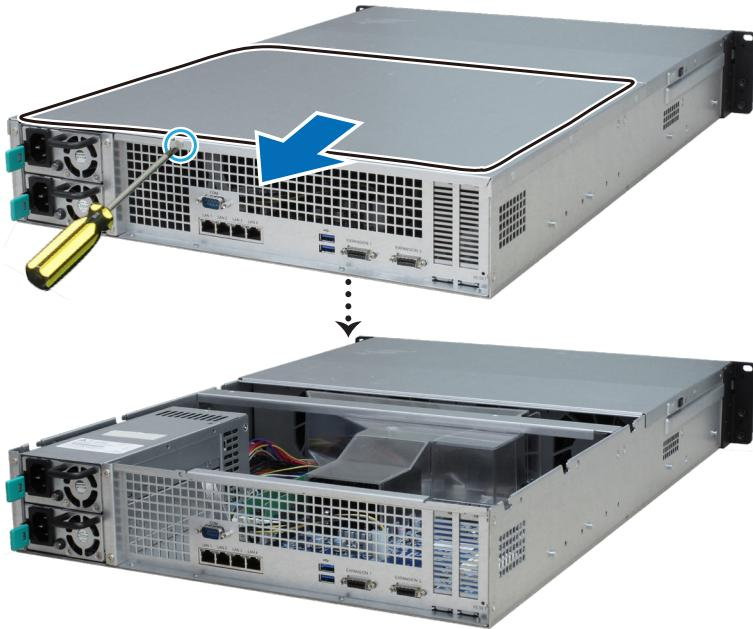
**Примечание.** После снятия верхней крышки задней части устройства чувствительные внутренние компоненты остаются без защиты от внешних воздействий. Не трогайте внутренние компоненты, кроме блока памяти при его извлечении или установке.
