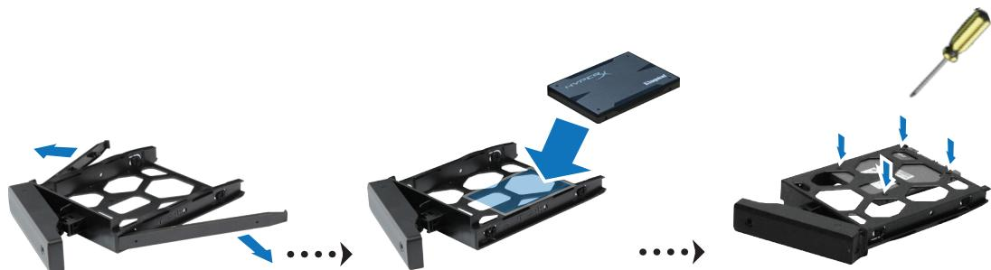
**4** Вставьте лоток с установленным жестким диском в пустой отсек для жестких дисков и нажмите на верхнюю половину ручки, чтобы закрепить его положение.
