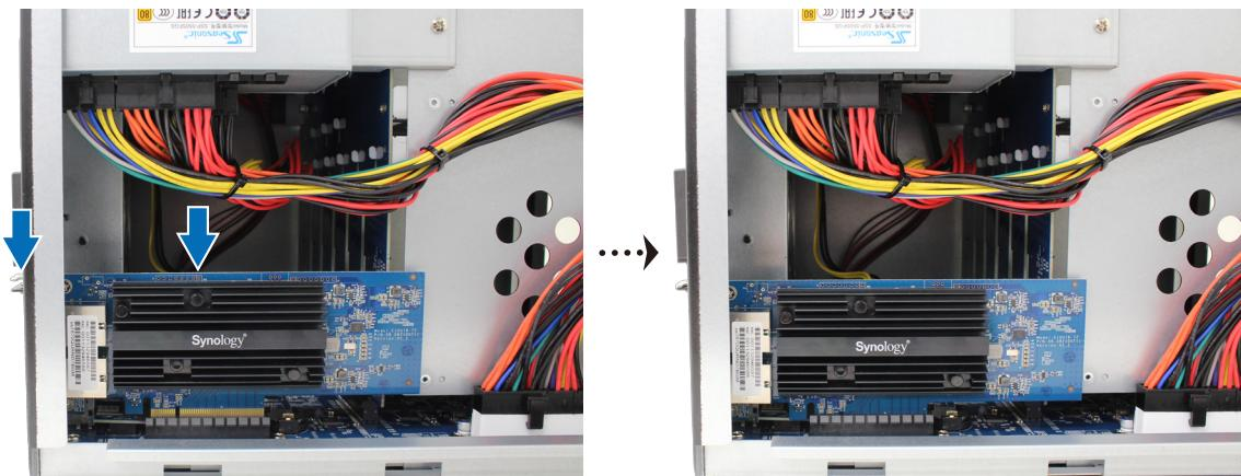
**c** Задвиньте фиксатор, чтобы зафиксировать только что вставленную плату.
