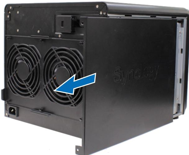
**Примечание.** После снятия крышки чувствительные внутренние компоненты остаются без защиты от внешних воздействий. Не трогайте внутренние компоненты, кроме блока памяти при его извлечении или установке.
