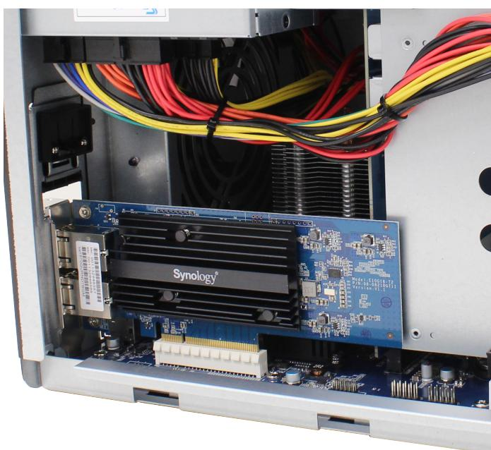
**b** Двумя пальцами равномерно надавите на плату и зажим.
