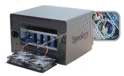
с Открутите 4 винта, которые крепят неисправный вентилятор, и снимите вентилятор.
