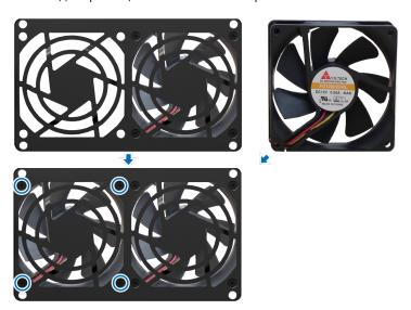
**b** Подключите 2 кабеля вентилятора к разъемам, расположенных возле нижней части разъема вентилятора, затем установите панель вентилятора.
