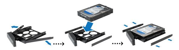
• Для дисков 2,5 дюйма: Извлеките крепежные панели, расположенные по бокам лотка диска, и положите их в надежное место. Установите диск в отмеченную синим цветом область лотка (см. ниже). Переверните лоток верхней стороной вниз и затяните винты для фиксации жесткого диска.
