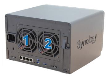
3 Вывинтите 4 винта, которые крепят панель вентилятора.
