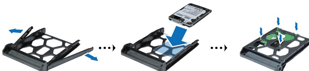
4 Вставьте лоток с установленным диском в пустой отсек для дисков. Поверните диск стороной с отметкой "UP" кверху и вставьте его в отсек для дисков. Если лоток вставлен правильно, раздастся щелчок.
