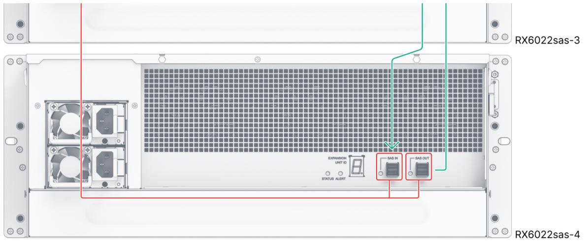
2. Подключите один конец кабеля питания к порту питания устройства RX6022sas, а другой конец — к розетке питания. При правильном подключении кабелей питания питание устройства RX6022sas включится автоматически.
