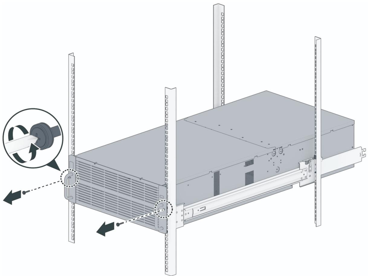
2. Выдвиньте шасси из стойки.
