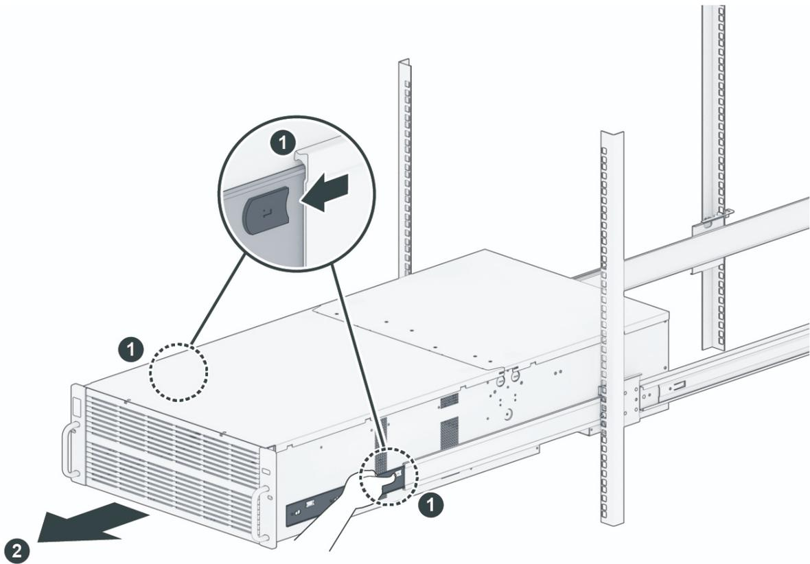
4. Извлечение комплекта направляющих из устройства Synology NAS.
