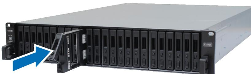
**Примечание.** Убедитесь, что лоток задвинут до упора. В противном случае в работе диска могут возникнуть неполадки.
