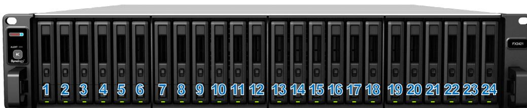
**Примечание.** Рекомендуется устанавливать диски одинакового размера для оптимизации использования емкости дисков при создании томов RAID.
