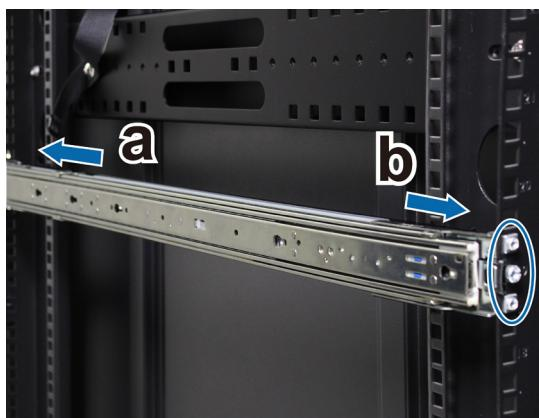
2 Выдвиньте и извлеките внутреннюю направляющую из узла.
