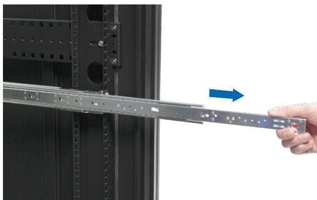
3 Совместите крепежные отверстия внутренней направляющей с точками крепления на боковой панели шасси. Сдвиньте внутреннюю направляющую от передней панели, чтобы прикрепить ее к шасси.
