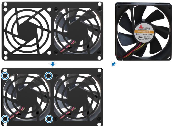
b Подключите 2 кабеля вентилятора к разъемам, расположенным возле нижней части разъема вентилятора, затем установите панель вентилятора.
