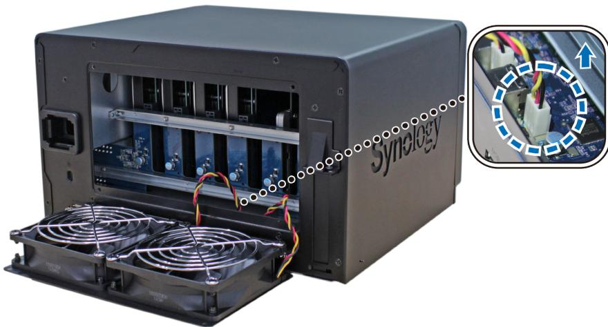
**c** Открутите 4 винта, которые крепят неисправный вентилятор, и снимите вентилятор.
