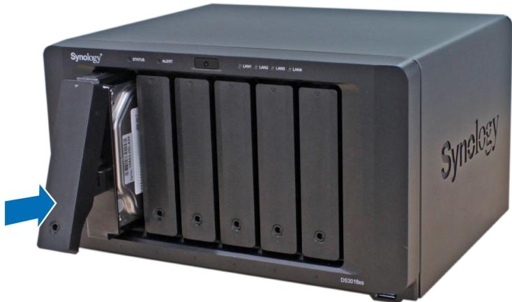
**Примечания.** Убедитесь, что лоток задвинут до упора. В противном случае в работе диска могут возникнуть неполадки.
