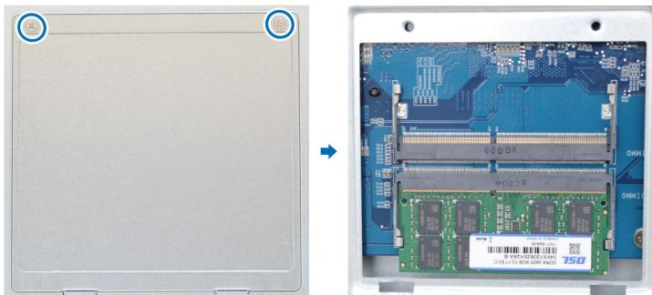
**Важно!** При снятии крышки вы подвергаете чувствительные внутренние компоненты внешнему воздействию. Не трогайте внутренние компоненты за исключением блока памяти, который вы собираетесь извлечь или добавить.
