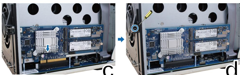
**5 Установите верхнюю крышку, удаленную в шаге 2, и закрутите винты.**
