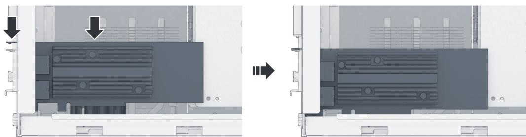
**с** Задвиньте фиксатор, чтобы зафиксировать только что вставленную плату.
