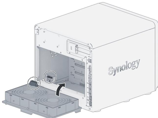
**b** Перед тем как поместить новый модуль в Synology NAS, убедитесь, что все 6 креплений выдвинуты наружу. После установки модуля верните их в прежнее положение, чтобы зафиксировать модуль вентилятора.
