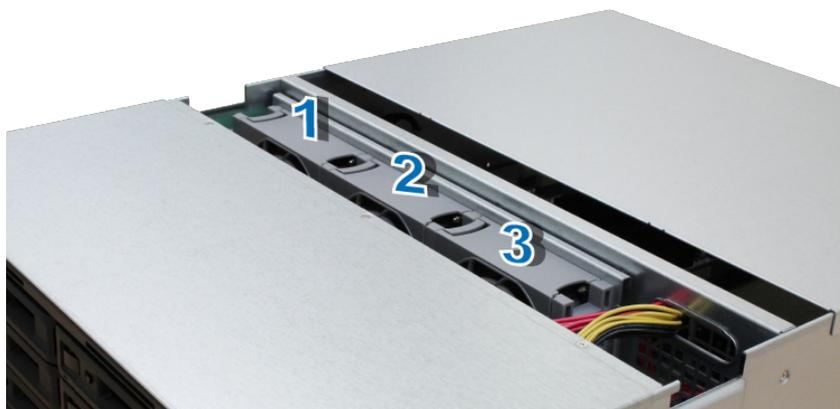
4 Найдите неисправный вентилятор. Поднимите вентилятор вверх и снимите его.
