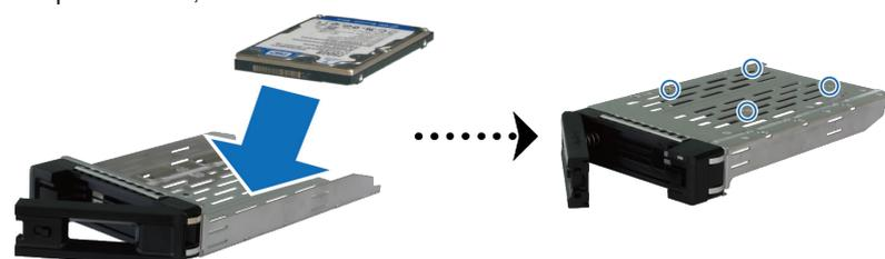
3 Вставьте лоток с установленным диском в пустой отсек для дисков.
