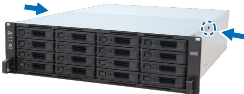
2 Поднимите крышку вентилятора и снимите ее.
