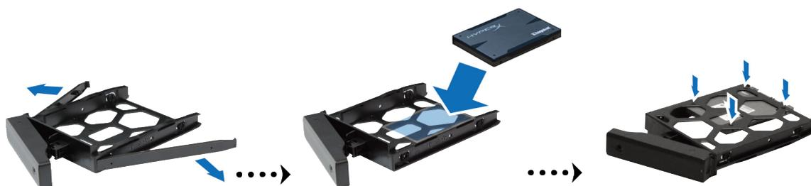
4 Вставьте лоток с установленным жестким диском в пустой отсек жестких дисков.
